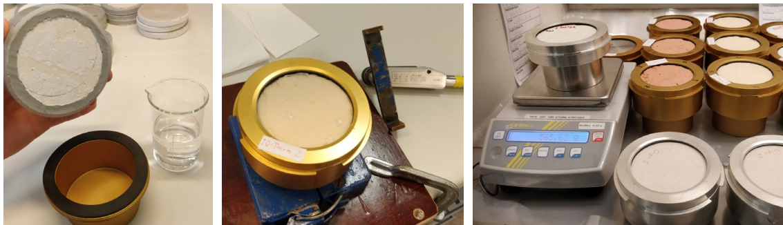
Figur 3. Klargøring isoleringssystemerne til VOC-test og periodisk vejning af kopperne.
