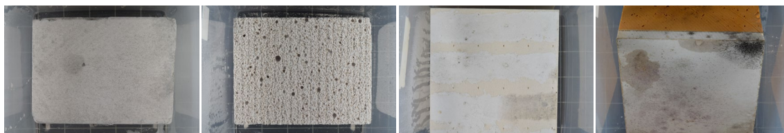
Figur 7. Calsitherm (til venstre), Multipor, IQ Therm og Kingspan efter 3 måneders inkubering uden kunstig podning. Der ses kun vækst på Kingspan (til højre).
